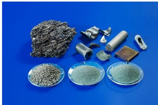
**Abb. 3** Die Forschenden arbeiten daran, zukünftig auch defekte oder verbrauchte keramikhaltige Komponenten als Basis für hochwertiges SiC nutzen zu können.
