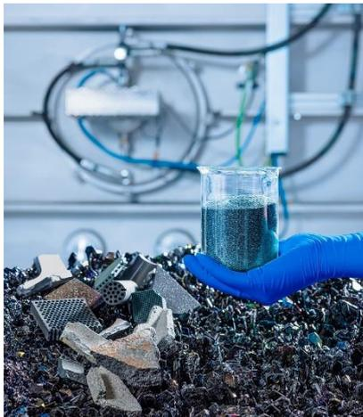
**Abb. 1 RECOSiC® nutzt Nebenabfälle aus dem Acheson-Verfahren und verwandelt diese im geschlossenen Hightech-Ofen in hochreines Siliciumcarbid. Das SiC liegt am Ende in Pulverform vor.**
